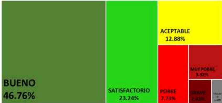
Figura 5 Estado de la malla vial en términos generales de la localidad de barrios unidos
