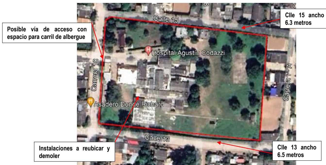
Figura 2 Relación de las construcciones existentes vecinas al proyecto y su ruta de acceso posible. .
