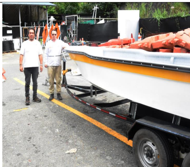
Entrega material de un bote/lancha tipo pesquero en fibra de vidrio (eslora 4,22 m, manga 1,47 m, puntal 0,61 m, 2 bancas)
