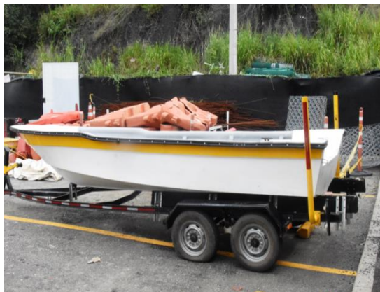
Bote/lancha tipo pesquero en fibra de vidrio (eslora 4,22 m, manga 1,47 m, puntal 0,61 m, 2 bancas
