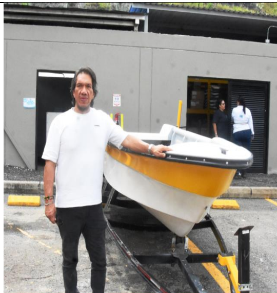
Bote/lancha tipo pesquero en fibra de vidrio (eslora 4,22 m, manga 1,47 m, puntal 0,61 m, 2 bancas
