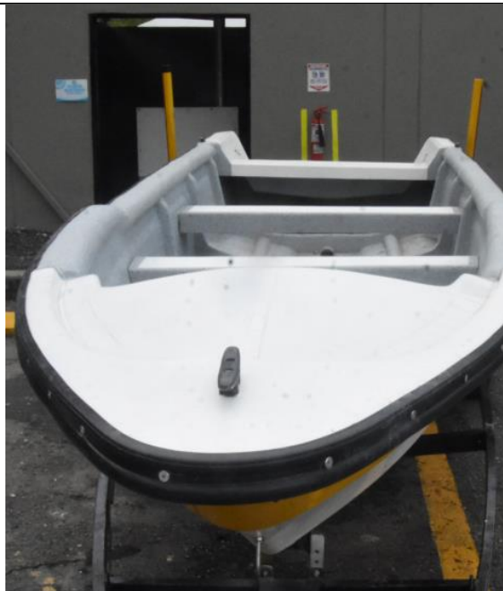
Bote/lancha tipo pesquero en fibra de vidrio (eslora 4,22 m, manga 1,47 m, puntal 0,61 m, 2 bancas
