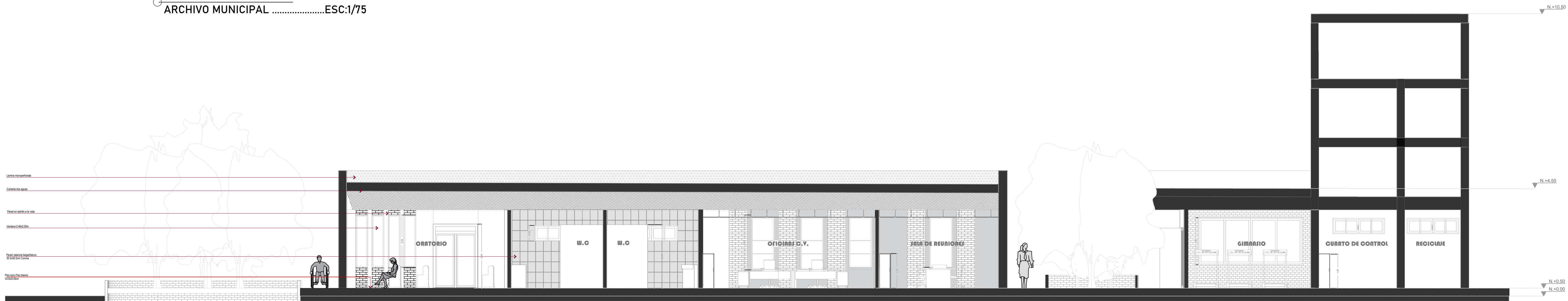
CORTE LONGITUDINAL B-B' ARCHIVO MUNICIPAL .....ESC:1/75
