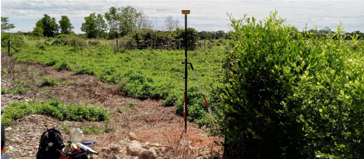
Ilustración 5 Lectura con GPS Hi target GNSS-02
