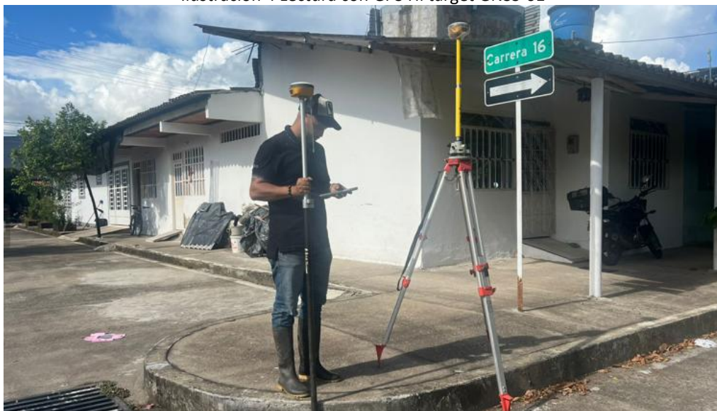
Ilustración 4 Lectura con GPS Hi target GNSS-01
