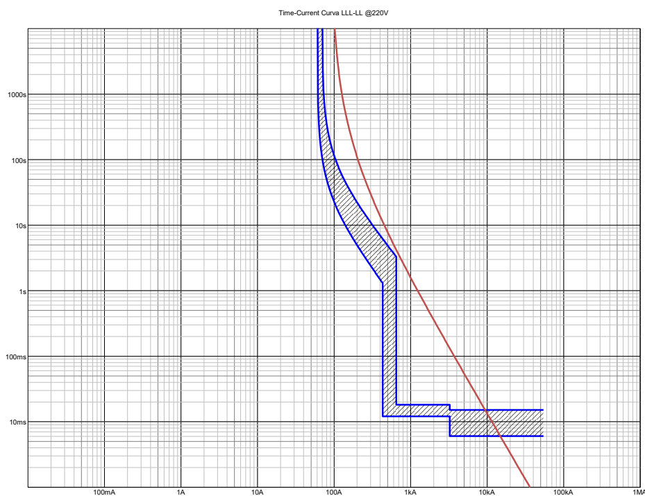
Figura 4. Verificación del conductor calibre No 10 y protección.
