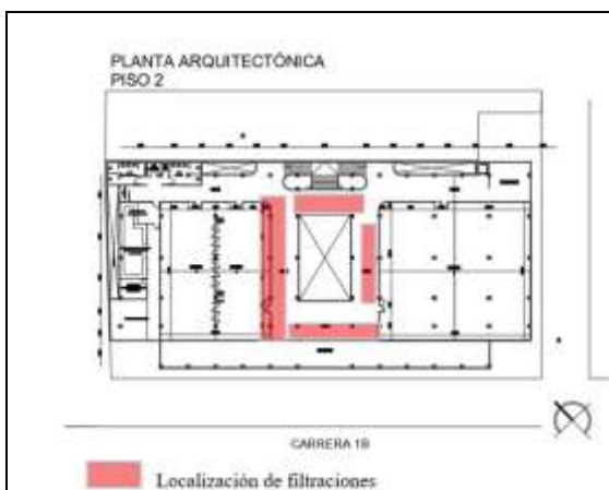
Figura 35. Piso 2 – Localización de cielos falsos afectados por filtraciones
