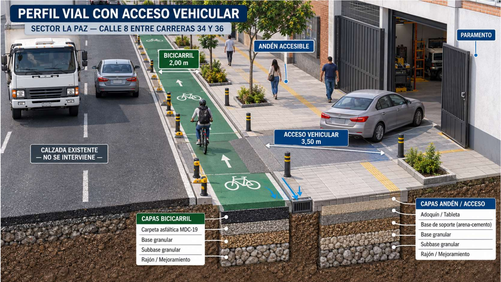
Figura 6. Solución conceptual para un acceso vehicular que cruza el bicicarril y el andén.
