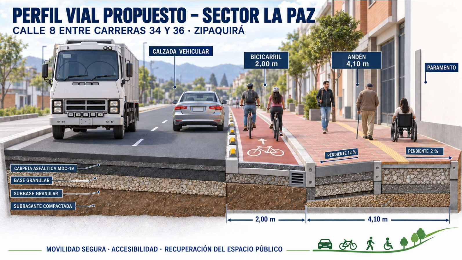
Figura 4. Esquema tridimensional del perfil vial con calzada existente, bicicarril y andén.
