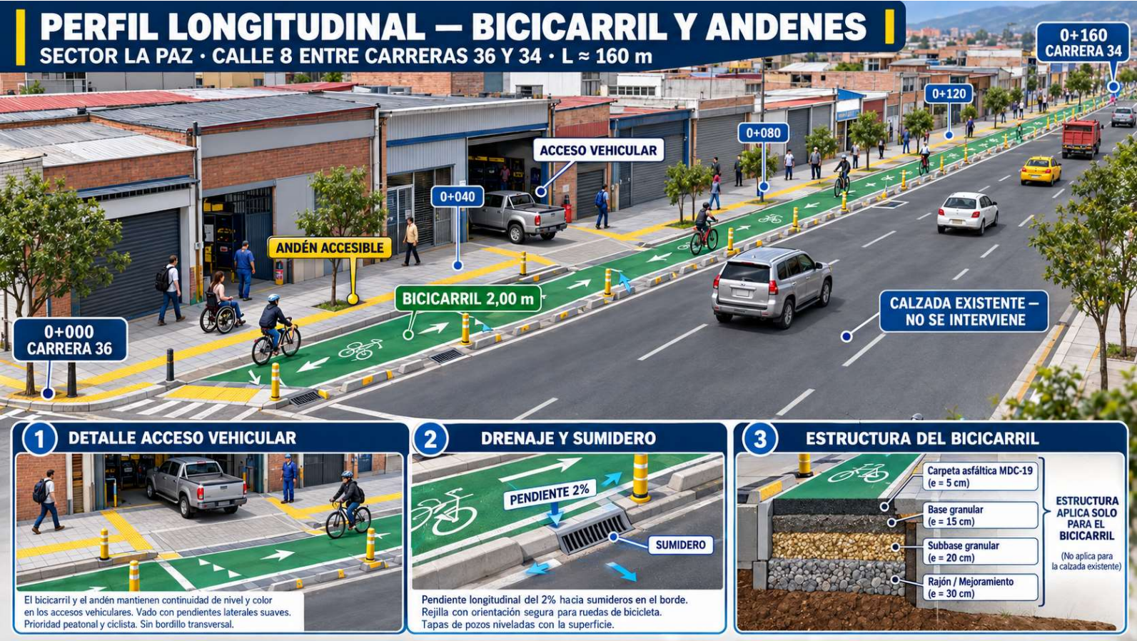
Figura 8. Lectura longitudinal preliminar del corredor con un acceso vehicular representativo.
