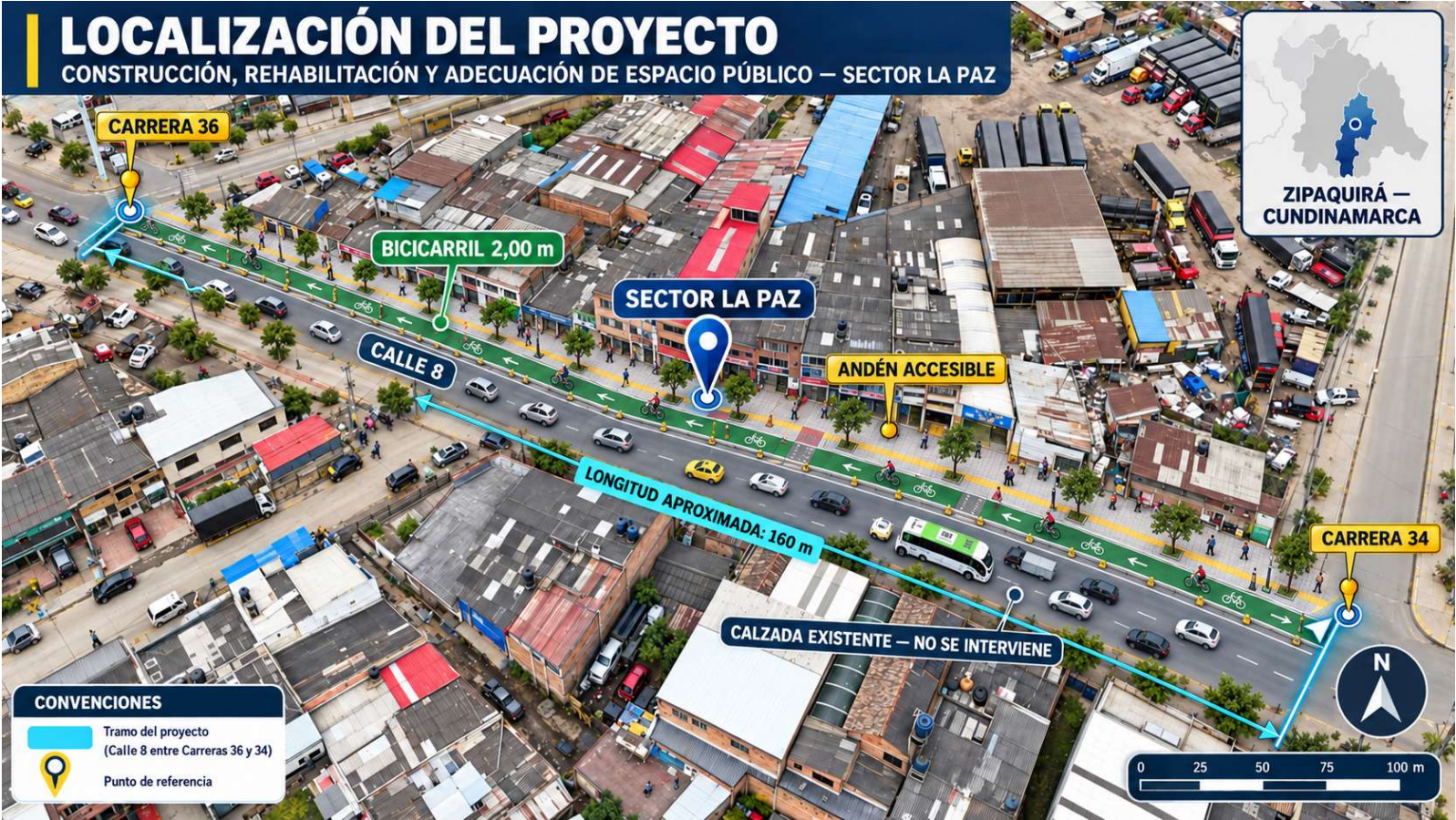
Figura 3. Implantación conceptual del bicicarril y del andén accesible a lo largo del corredor.
