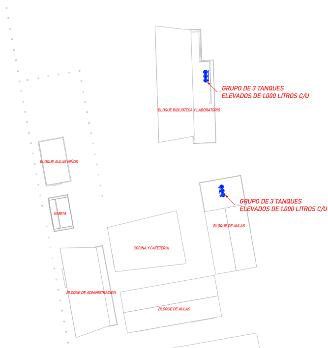
Ilustración 1. Ubicación de grupo de tanques.
