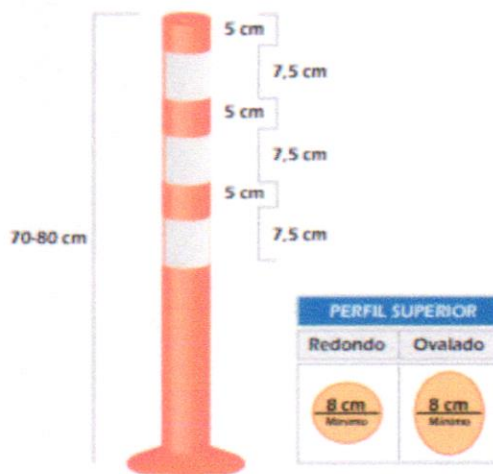
Ilustración 16. Delineadores tubulares simples
