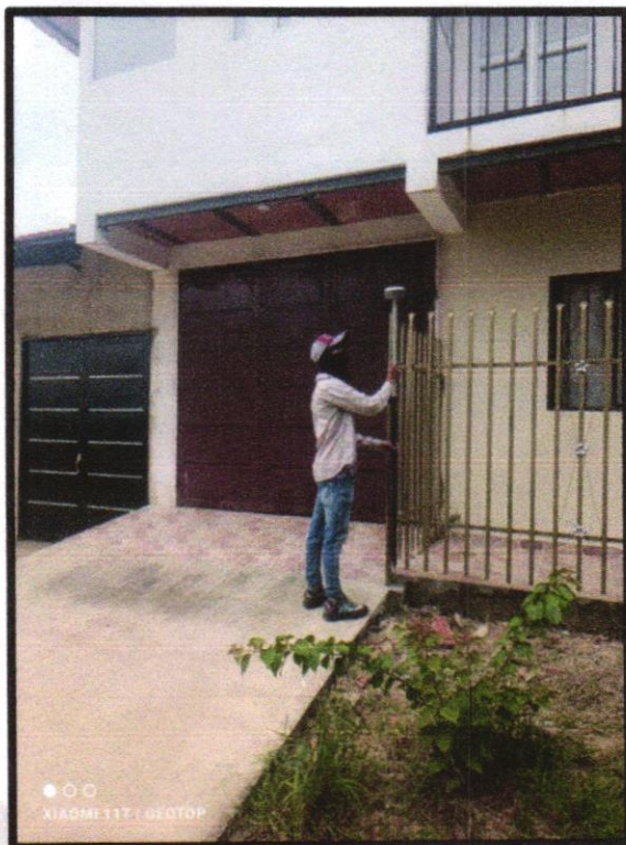
TOMA DE DETALLES ANDENES Y PARAMENTOS
