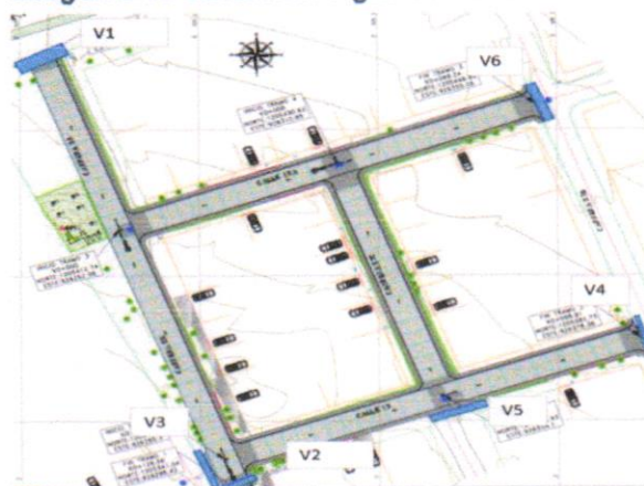
Imagen 6-16 Ubicación Vigas de confinamiento
