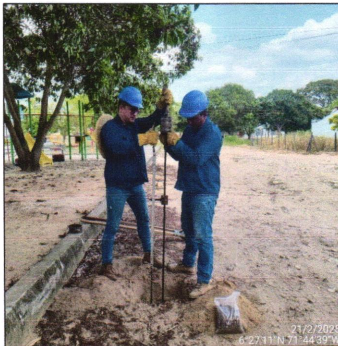
Foto 5. Ensayo de Penetración Dinámica de Cono (PDC) Apique A-02
