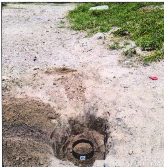
Foto 15. Toma de muestra inalterada en molde CBR Apique A-05
