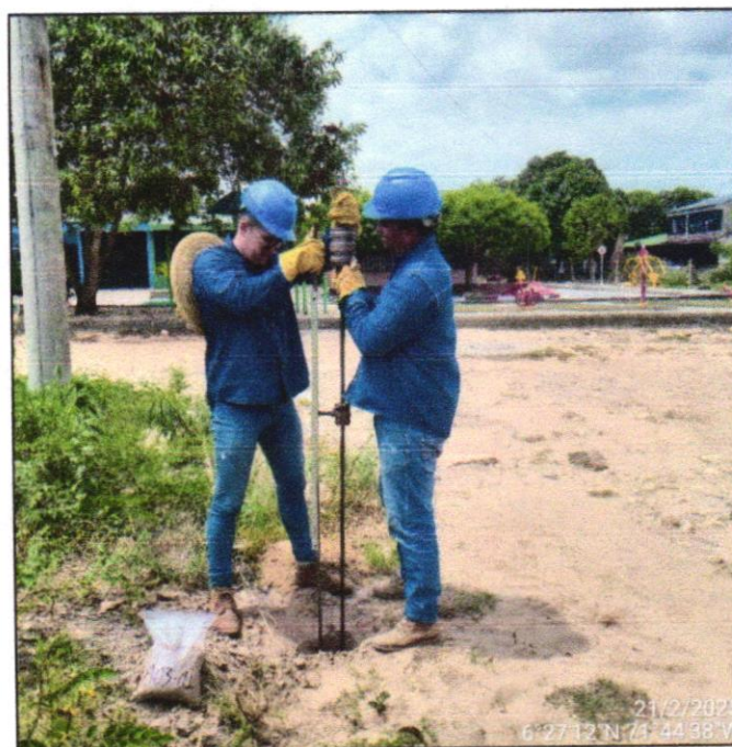
Foto 8. Ensayo de Penetración Dinámica de Cono (PDC) Apique A-03
