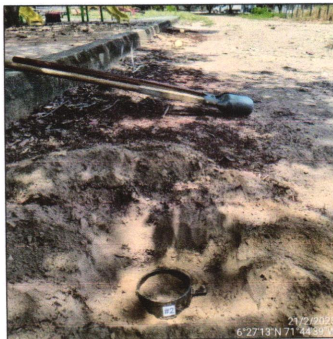
Foto 6. Toma de muestra inalterada en molde CBR apique A-02
