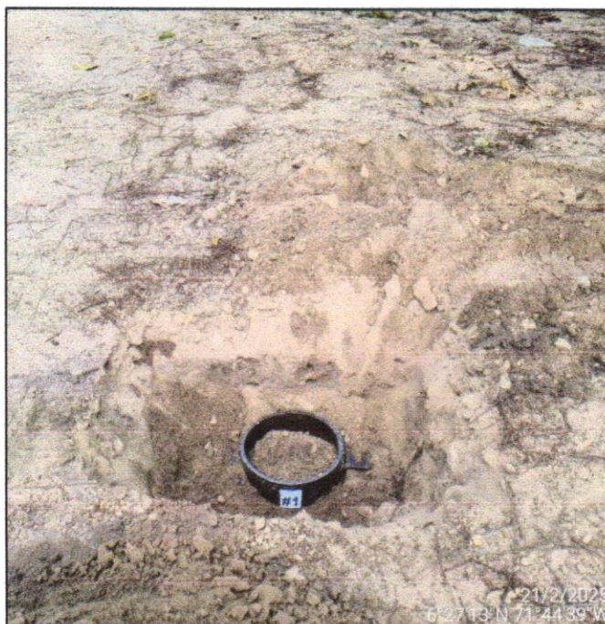
Foto 3. Toma de muestra inalterada en molde CBR apique A-01
