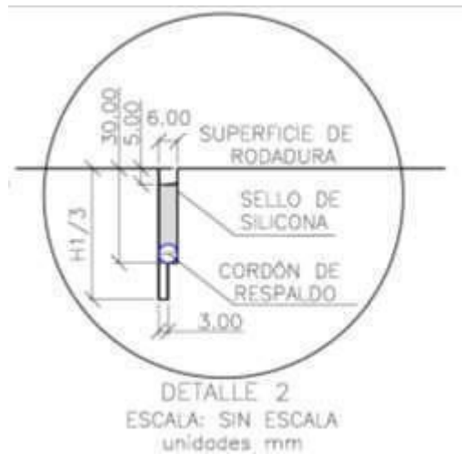
Figura 6. Detalle sello de juntas con doble corte y cordón de respaldo Fuente. Cartilla invias.
