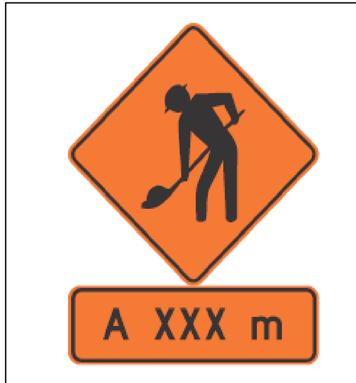
Figura 12. SPO-01 Trabajos en la vía
