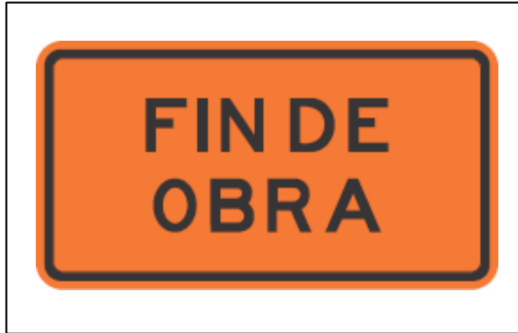
Figura 17. SIO-03 Fin de obra
