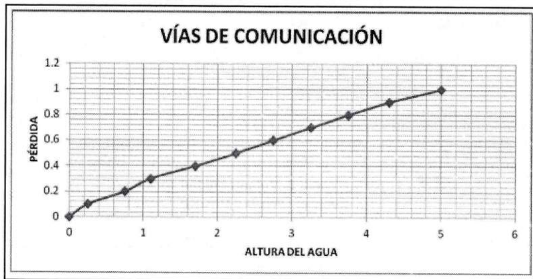
Figura 3. Curva de vulnerabilidad en las vías.
