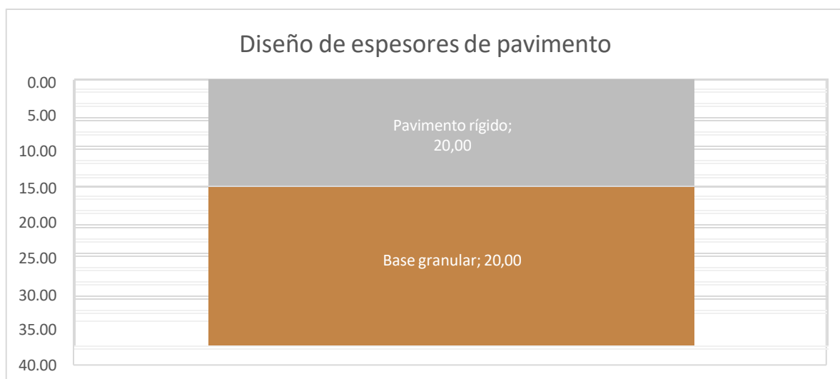
Figura 17. Estructura de pavimento de la predimensión Fuente: : elaboración propia consultoría
