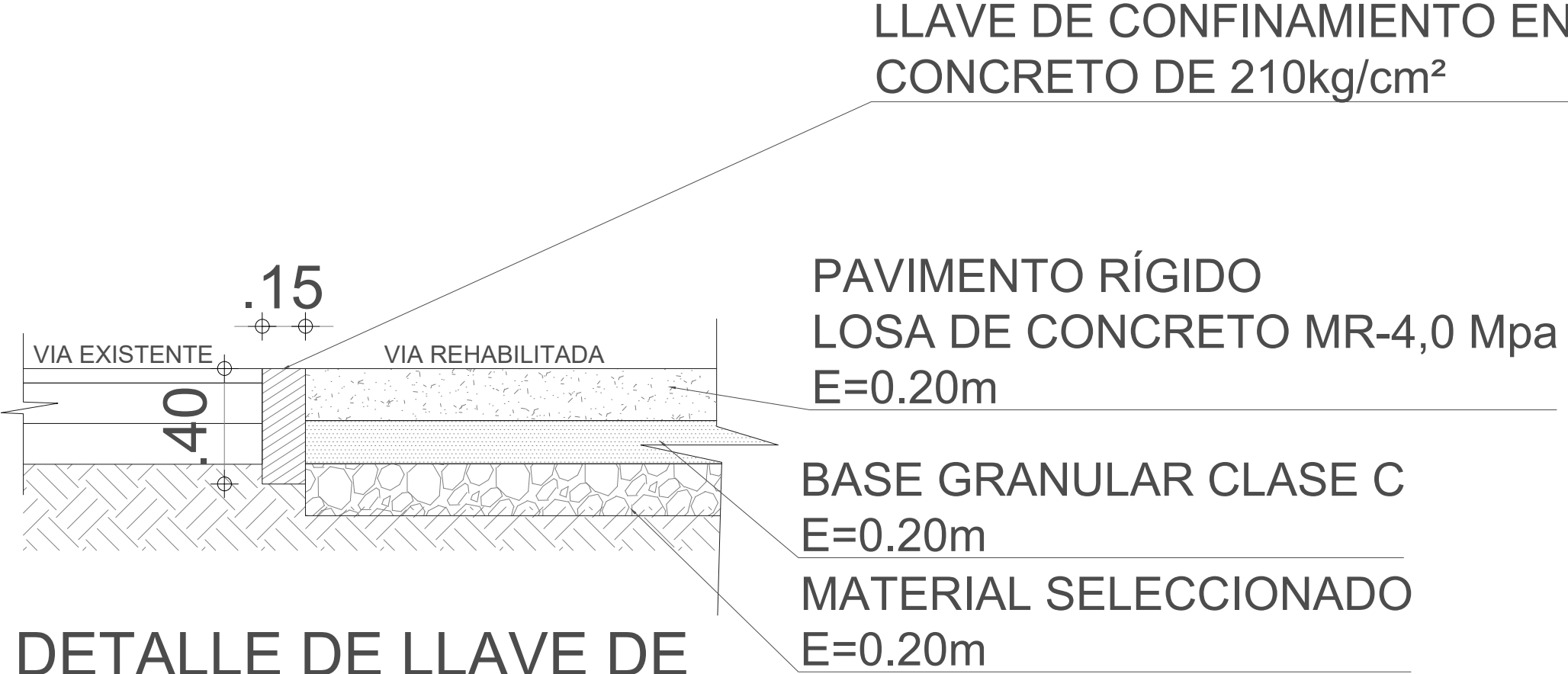
DETALLE DE LLAVE DE CONFINAMIENTO
