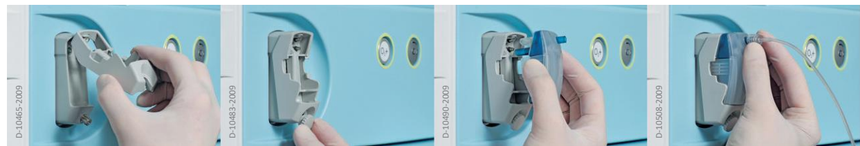
Ponga el adaptador Atornille el adaptador Introduzca el nuevo WaterLock® 2 Conecte el tubo de muestreo
