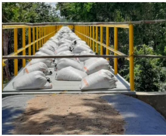
Incremento de Carga ultima luz
