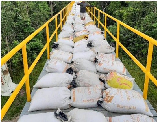
Incremento de carga ultimo estado 100%
