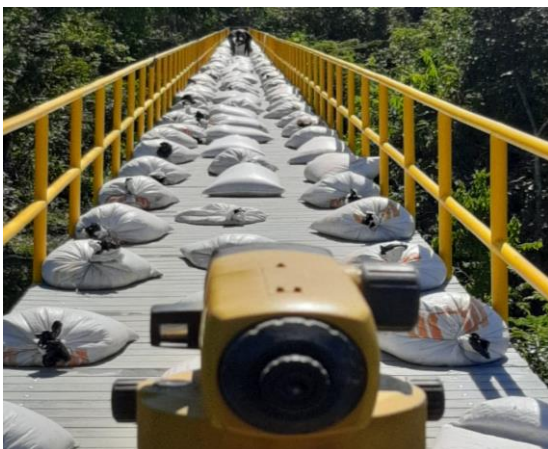
Toma de nivelación para medir deflexión.
