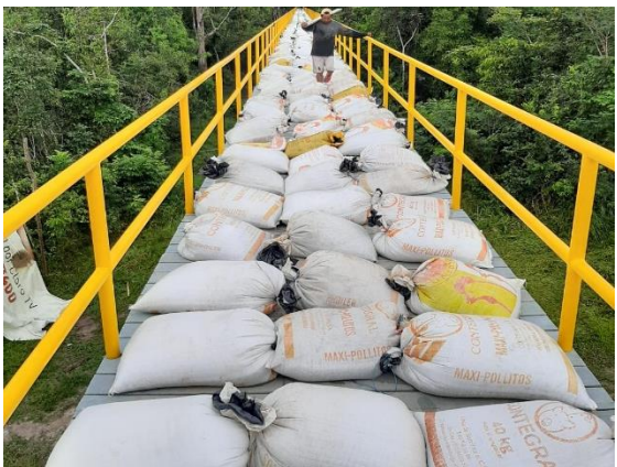
Incremento de carga ultimo estado 100%
