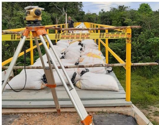
Toma de nivelación para medir deflexión.
