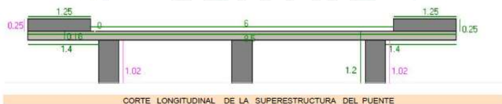
Figura 1. Corte longitudinal de la superestructura del puente
