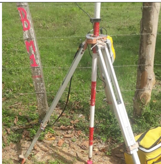
Posicionamiento – GPS Doble Frecuencia BM1
