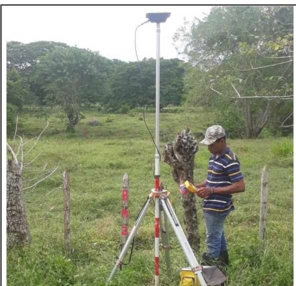
Posicionamiento – GPS Doble Frecuencia BM2
