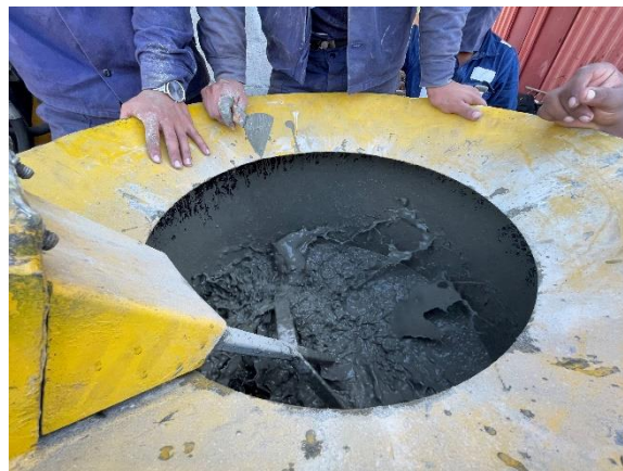
Imagen 10. Elaboración de probetas de la lechada agua/cemento según diseño entregado a interventoría Cemento: 42.5 Kg + 22 Lts de agua + 191 cc de Glenium + 191 cc Polyheed.
