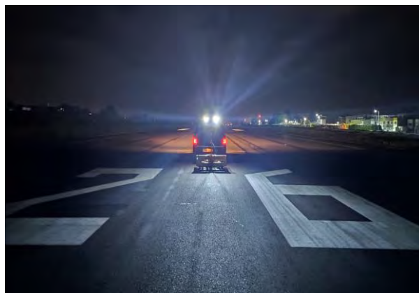
FOTO 12: MEDICION DE COEFICIENTE DE ROZAMIENTO ZONAS DESCONTAMINADAS
