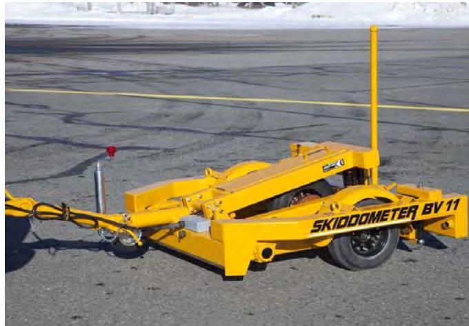
Figura 04. Equipo Skyddometer – Fuente manual Skyddometer
